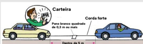
Como rebocar um veículo avariado sem levantar suas rodas
